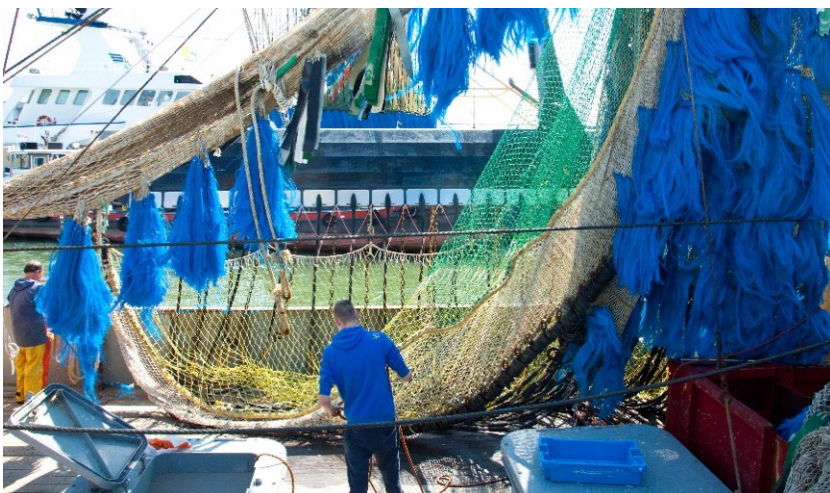
Figuur 2.1 Vispluis bevestigd onder een visnet Foto: W.J. Strietman.
