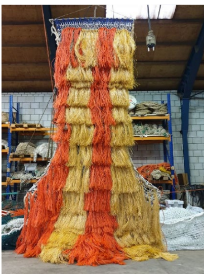
Figuur 3.2 Biopluis (geel) gemixt met conventioneel vispluis (oranje) op een net van één van de bij de tests betrokken kotters
