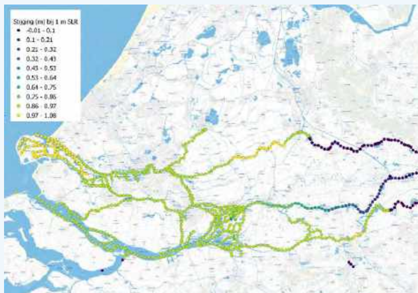
Figuur 26. Doorwerking van 1 meter zeespiegelstijging op stijging rivierwaterstanden bij mediane rivierafvoer (1961 m 3 /s bij Lobith). De doorwerking wordt scherp begrensd door de stuwen bij Hagestein en Lith, en de Volkeraksluizen (gebaseerd op De Jong, 2020).
