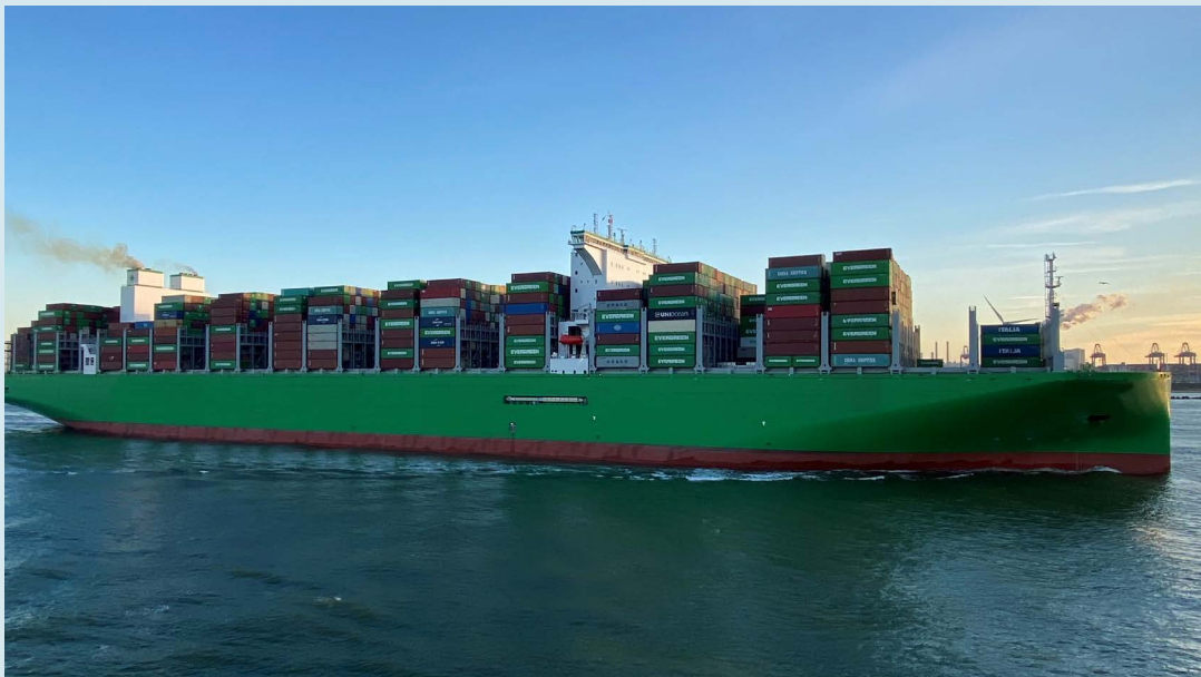
▲ Figuur 12: Voorbeeld van een windgevoelig schip, een Ultra Large Container Ship (ULCS) met een lengte van 400 meter en een breedte van 61,50 meter.
